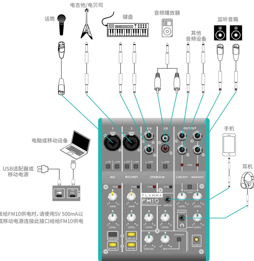
\*注:当连接的设备无法给FM10供电时,请使用5V 500mA以上的USB适配器或移动电源连接此接口给FM10供电
